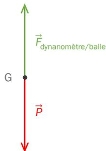
**12 a.** La descente est verticale et à vitesse constante donc le mouvement du système est rectiligne uniforme. D'après le principe d'inertie, les forces qui s'exercent sur le système se compensent.
