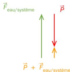
**c.** D'après la contraposée du principe d'inertie, la somme vectorielle des forces n'est pas nulle, le mouvement n'est pas rectiligne uniforme : le vecteur vitesse  $\vec{v}_G$  varie.
