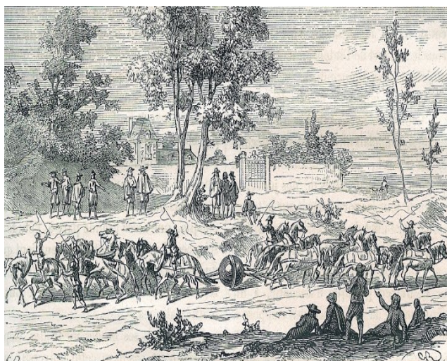
En 1680 Otto de Guericke réalise l'expérience des deux hémisphères. Il faut 24 chevaux pour séparer les deux hémisphères de 50 cm de diamètre, entre lesquels on a réalisé le vide.
