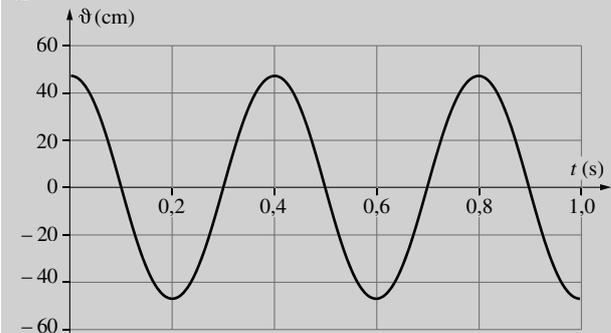
**3. a.**  $a = \ddot{x} = -x_m \cdot \left(\frac{2\pi}{T_0}\right)^2 \cdot \cos\left(\frac{2\pi}{T_0} \cdot t + \phi_0\right)$
