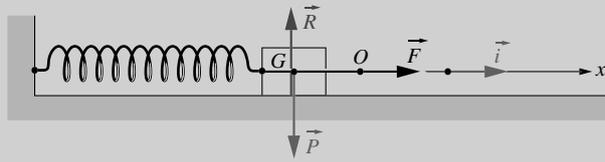
2. La masse est soumise à trois forces : le poids, la réaction du rail opposée au poids, la force de rappel du ressort.
