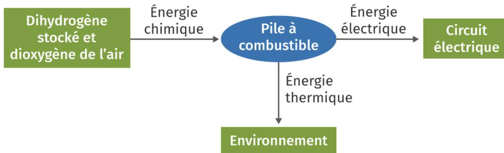
Diagramme de la chaîne énergétique de la pile à combustible en charge :
