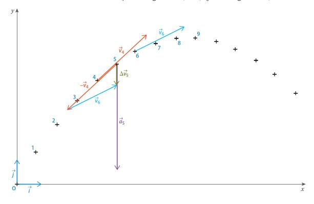
2.3. Sur le schéma la variation du vecteur vitesse a une longueur de 1.1 cm :  $\Delta v_5 = 2.2 \text{ m} \cdot \text{s}^{-1}$ 2.4. La norme du vecteur accélération est :
