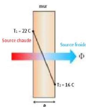
La surface du mur  $S = 20$  m<sup>2</sup>. Les températures  $T_1 = 22^\circ\text{C}$  et  $T_2 = 16^\circ\text{C}$ .
